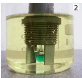
Per assicurarsi che la calibrazione sia effettuata correttamente le soluzioni devono essere a **temperatura ambiente** ed il sensore deve essere risciacquato tra una soluzione e l'altra. Si definiranno un minimo di 2 ed un massimo di 5 punti di calibrazione. Il sensore dovrebbe essere lasciato nella soluzione tampone per almeno 5 minuti prima di confermare la calibrazione per un determinato valore.
